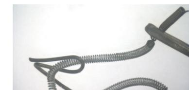
Glühfaden einer Glühbirne, geprüft mit ZEISS Visioner 1
