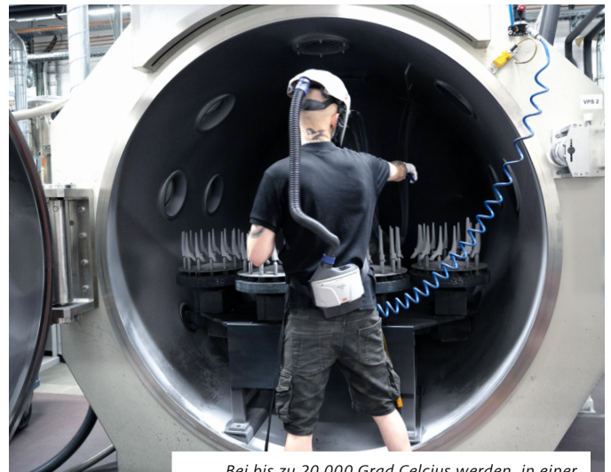
Bei bis zu 20.000 Grad Celsius werden, in einer Vakuumkammer, die Prothesen beschichtet.
