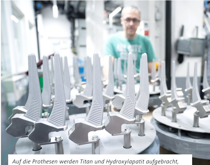
Auf die Prothesen werden Titan und Hydroxylapatit aufgebracht, der Beschichtungsprozess dauert mehrere Stunden.
