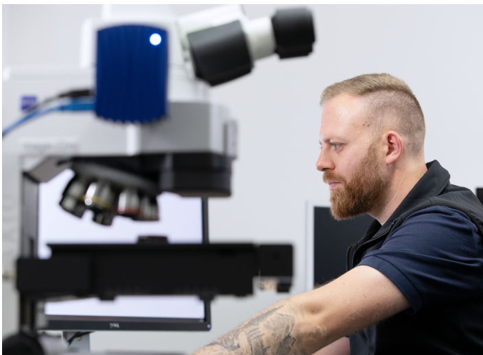
Messschritt 01: Bei Wareneingang erfolgt eine mikroskopische Materialanalyse mit dem ZEISS Axio Imager.
