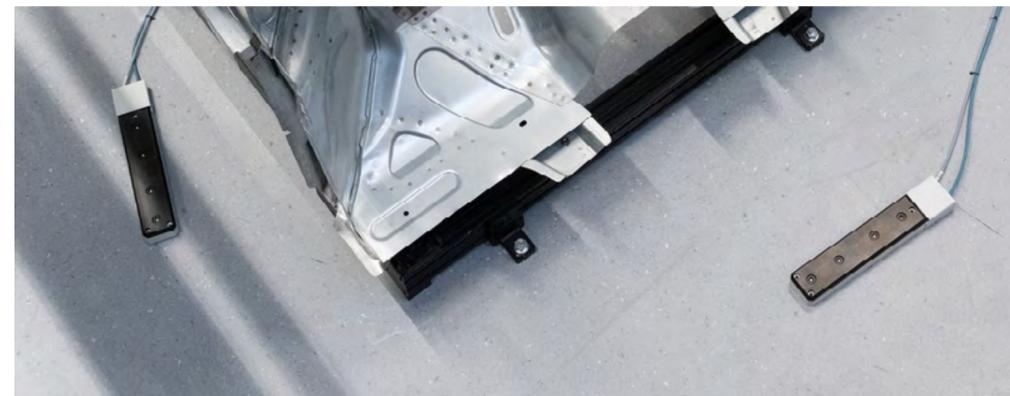
Stabilitätsmodule am Boden bilden eine feste Referenz für das Trackingsystem, besonders bei Temperaturschwankungen in der Produktionsumgebung.
