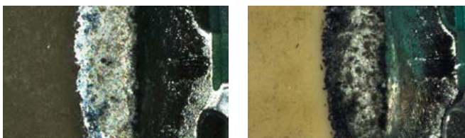
PCB-Komponente: ohne Polarisatoreinheit (links); mit Polarisator (rechts).
