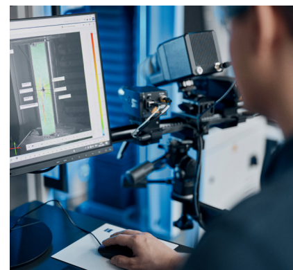
Rejestracja zachowania się próbki z otworem przy rozciąganiu z wykorzystaniem ZEISS ARAMIS
