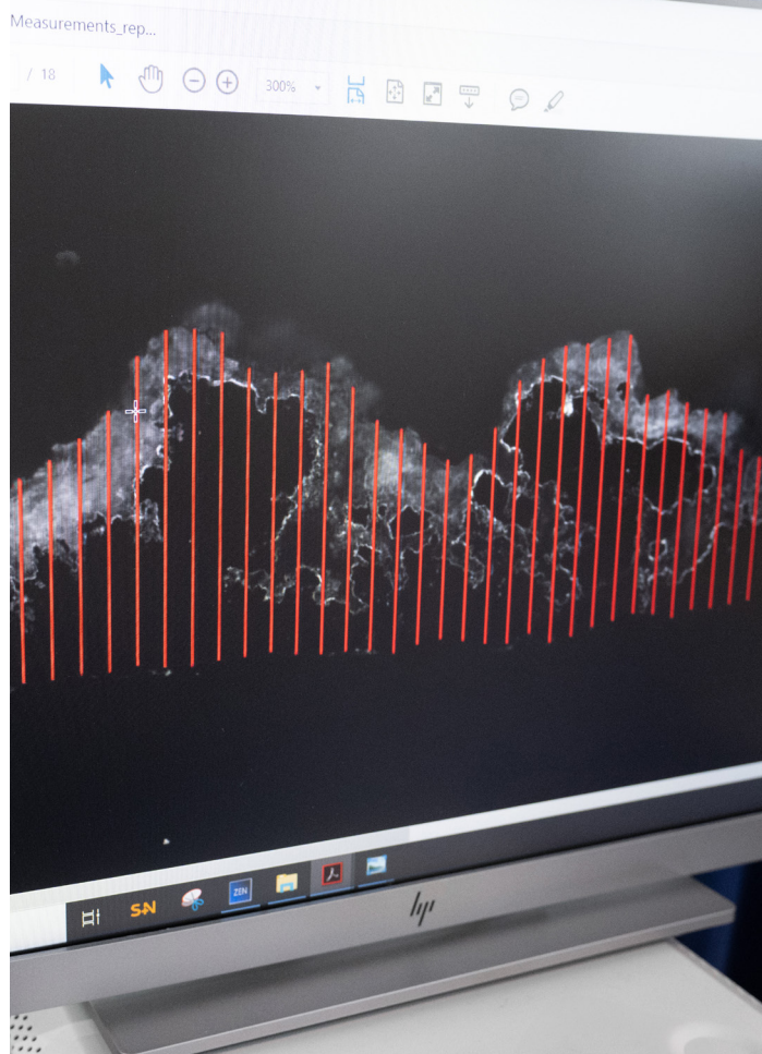
ZEISS ZEN core w pełni automatycznie ustala 343 pionowe linie i oblicza na ich podstawie grubość powłoki.
