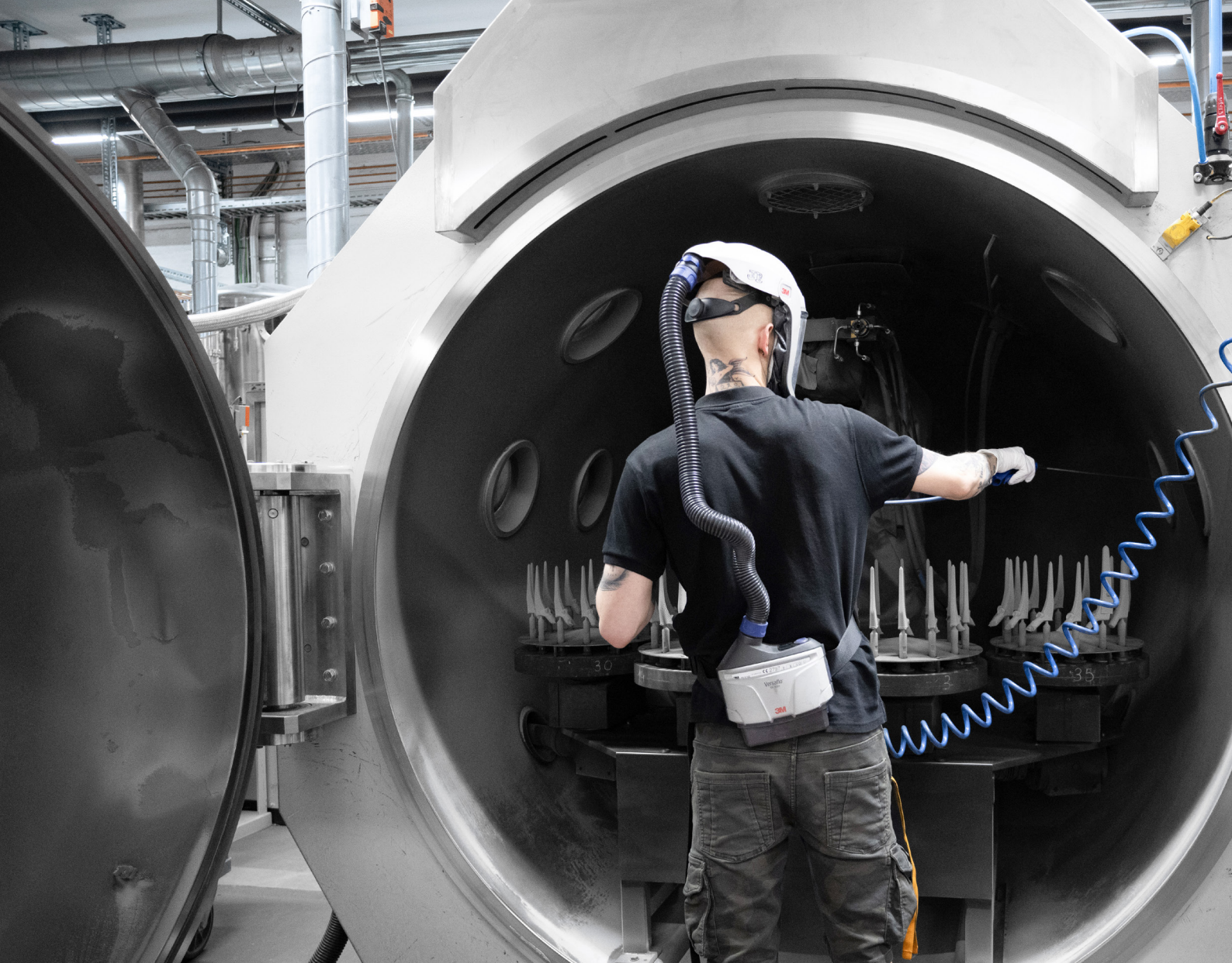
Protezy powlekane są w komorze próżniowej w temperaturze do 20 000 stopni Celsjusza
