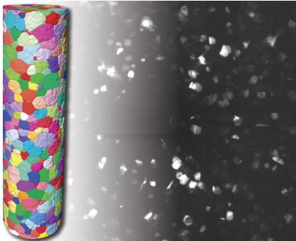
Struktura krystaliczna stopu alumińno-miedziowego, stosowanego m.in. w budowie samolotów ze względu na niski ciężar właściwy
