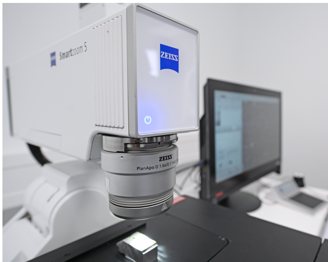
Vergößerung der Bruchfläche erfolgt mit dem Digitalmikroskop ZEISS Smartzoom 5.
