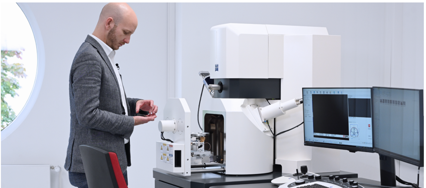
Im letzten Schritt galt es zu erkennen, aus welchen Materialien die Verunreinigung besteht. Hierfür prüften die Mitarbeiter einen metallografischen Schliff von der Ritzelwelle mit dem Rasterelektronenmikroskop ZEISS EVO.
