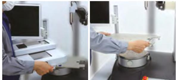
Der XY-Achsen-Verfahrtisch kann je nach Anwendung und Werkstück montiert und wieder entfernt werden.
