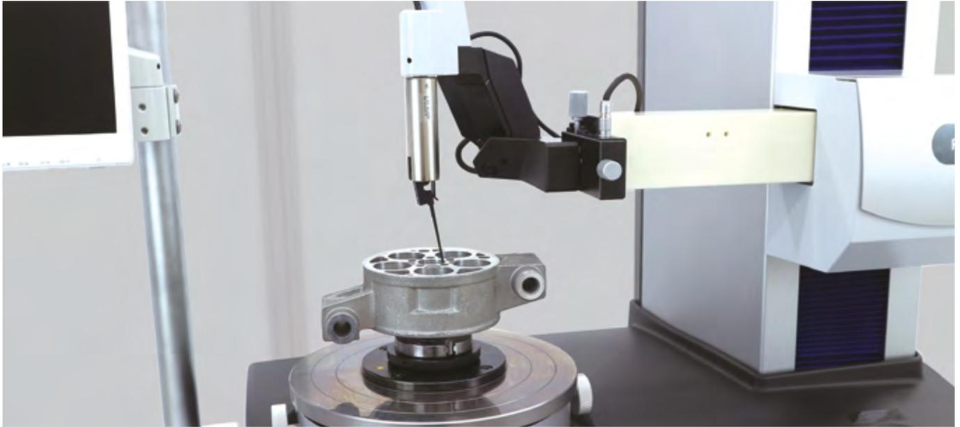
Offset-Detektorhalter ermöglicht Messungen unterhalb der R-Achse
