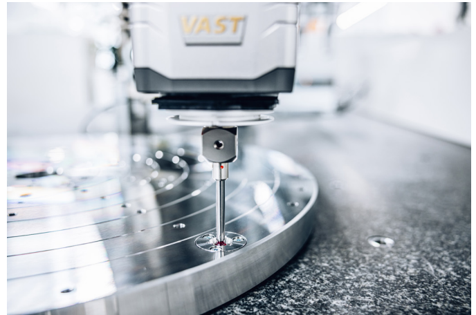
Verbesserung der Positioniergeschwindigkeit mit dem neuen Drehtisch der ZEISS PRISMO 7/12/7 fortis
