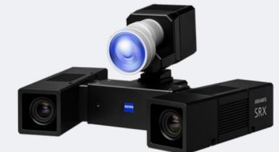
ARAMIS Sensoren ermöglichen die dynamische Erfassung von 3D-Koordinaten, 3D-Verschiebungen und 3D-Oberflächendehnungen. Auf Basis von Triangulation erfassen die Messsysteme präzise 3D-Koordinaten für vollflächige und punktbasierte Messungen.
