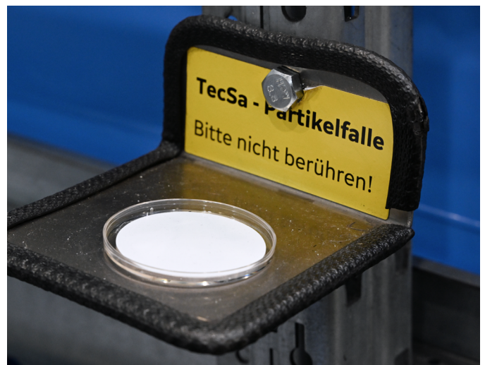
Der gesamte Prozess von der Warenanlieferung über die Fertigung bis hin zum Versand mit Partikelfallen überwacht.
