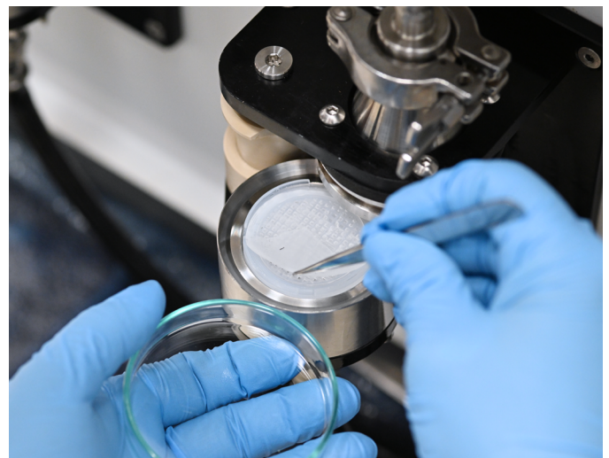
Wird eine Grenzwertüberschreitung festgestellt, wird der Analysefilter mit den Partikeln genauer untersucht.
