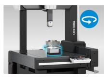
Der neue flexible Drehtisch kann je nach Bedarf als Aufbau-Variante im Messbereich installiert werden und danach wieder bequem aus dem Messbereich geschoben werden. Diese Option ermöglicht ein Messen in vier Achsen.
