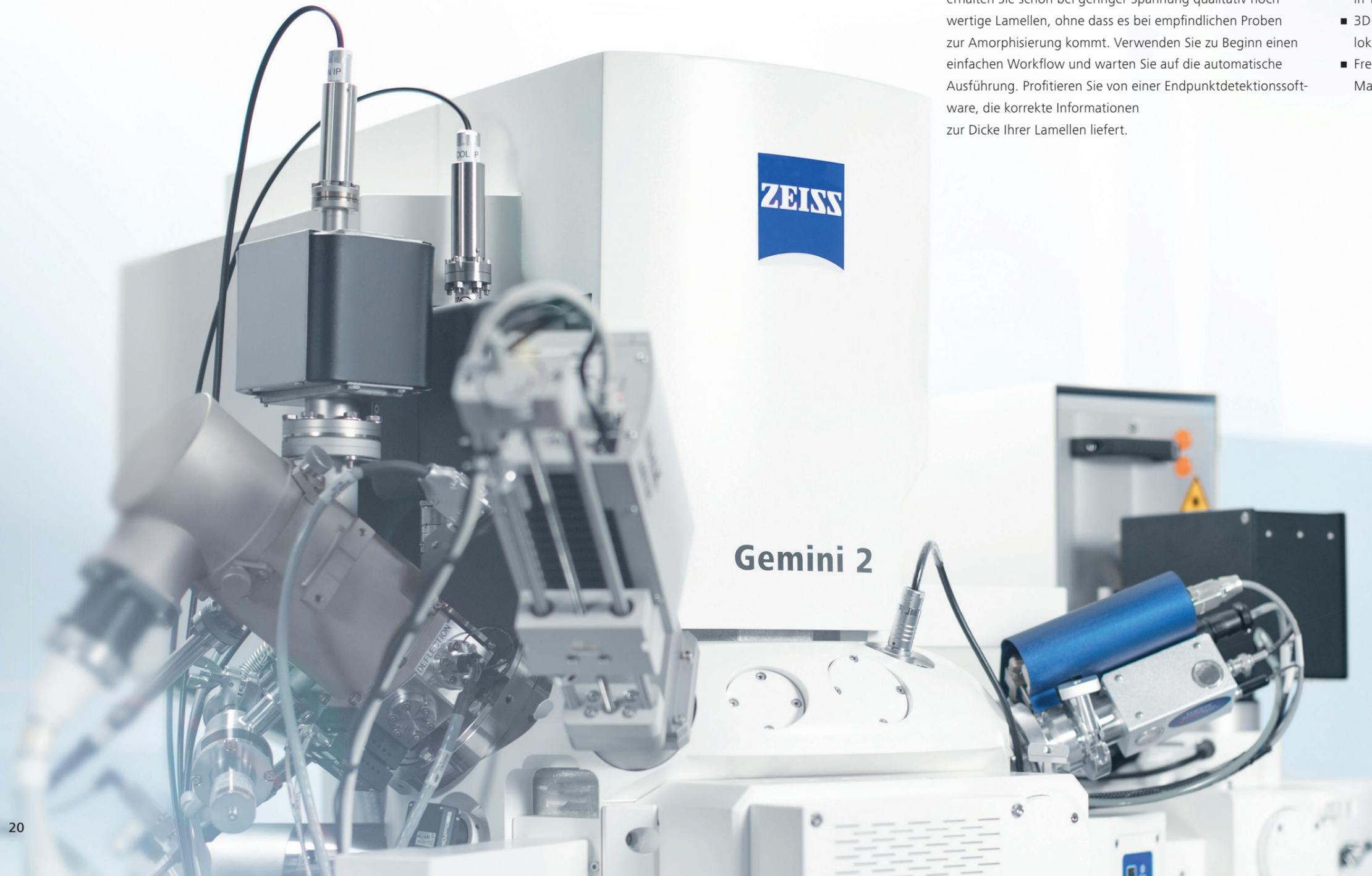
Bereiten Sie dünne Lamellen für die Analyse im Transmissionselektronenmikroskop (TEM) oder Rastertransmissionselektronenmikroskop (STEM) vor. ZEISS Crossbeam bietet eine umfassende Lösung für die Präparation von TEM-Lamellen, auch für Probensätze.
