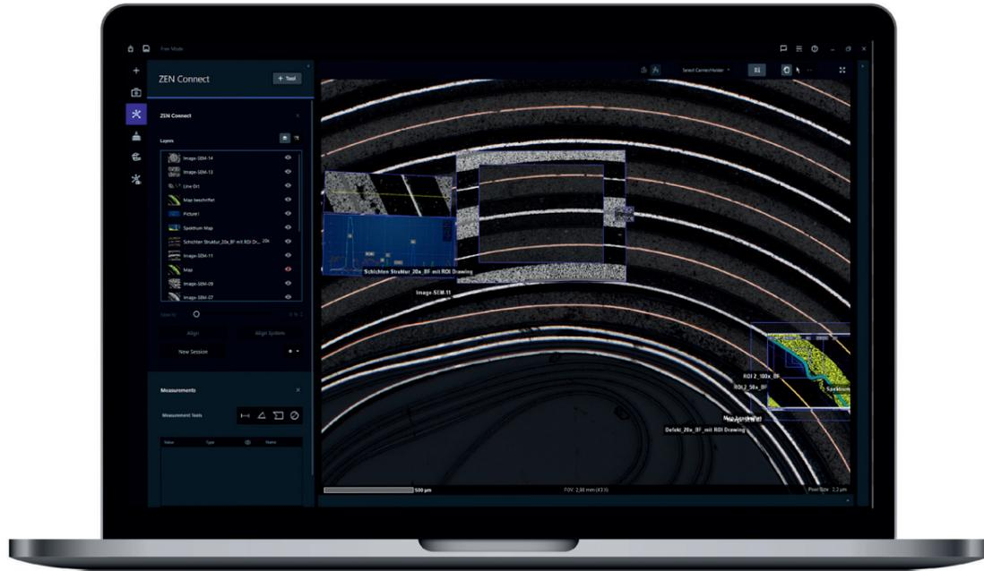
ZEISS ZEN Connect ermöglicht die korrelierte Darstellung von Bildern verschiedener Mikroskoptypen (z. B. Licht- und Elektronenmikroskop) in einer zusammenhängenden Darstellung. Besonders für die detaillierte Untersuchung von großen Übersichtsbildern, wie z. B. von Batteriezellen, ist dies ein großer Vorteil.
