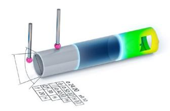
In der Qualitätsprüfung mit ZEISS Visioner 1 vor der Montage werden die Präzisionskunststoffteile auf Gussnähe, Kratzer und Gussgrate untersucht. Diese Angaben lassen sich zur Überwachung von Werkzeugproblemen dokumentieren. Ideal, wenn keine CT-Lösungen benötigt werden.
