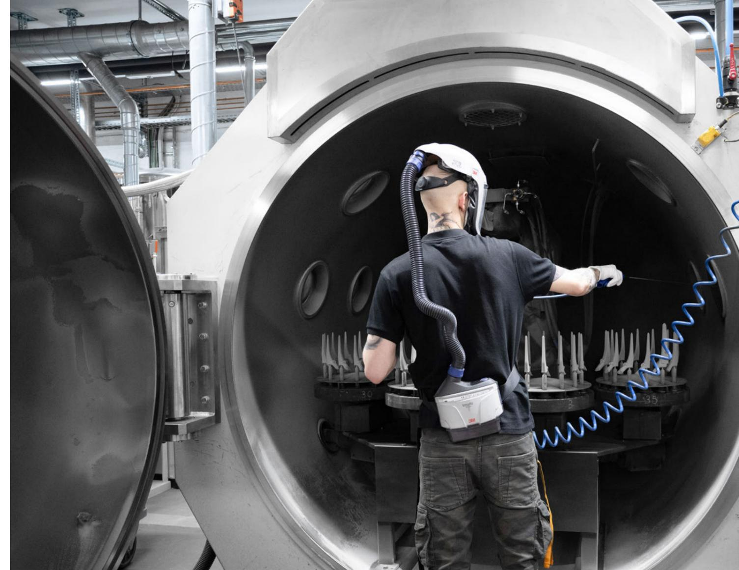
In der Vakuumkammer werden die Prothesen bei einer Temperatur von bis zu 20.000 Grad Celsius beschichtet
