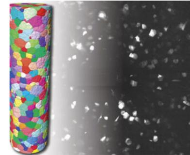
Kristallstruktur einer Aluminium-Kupfer-Legierung, eingesetzt beispielsweise im Flugzeugbau wegen des geringen spezifischen Gewichts
