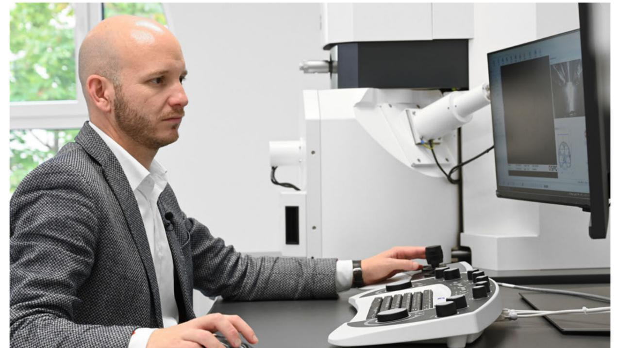
Mit dem Rasterelektronenmikroskop ZEISS EVO 15 konnte SPC auch die chemische Zusammensetzung der Verunreinigungen bestimmen
