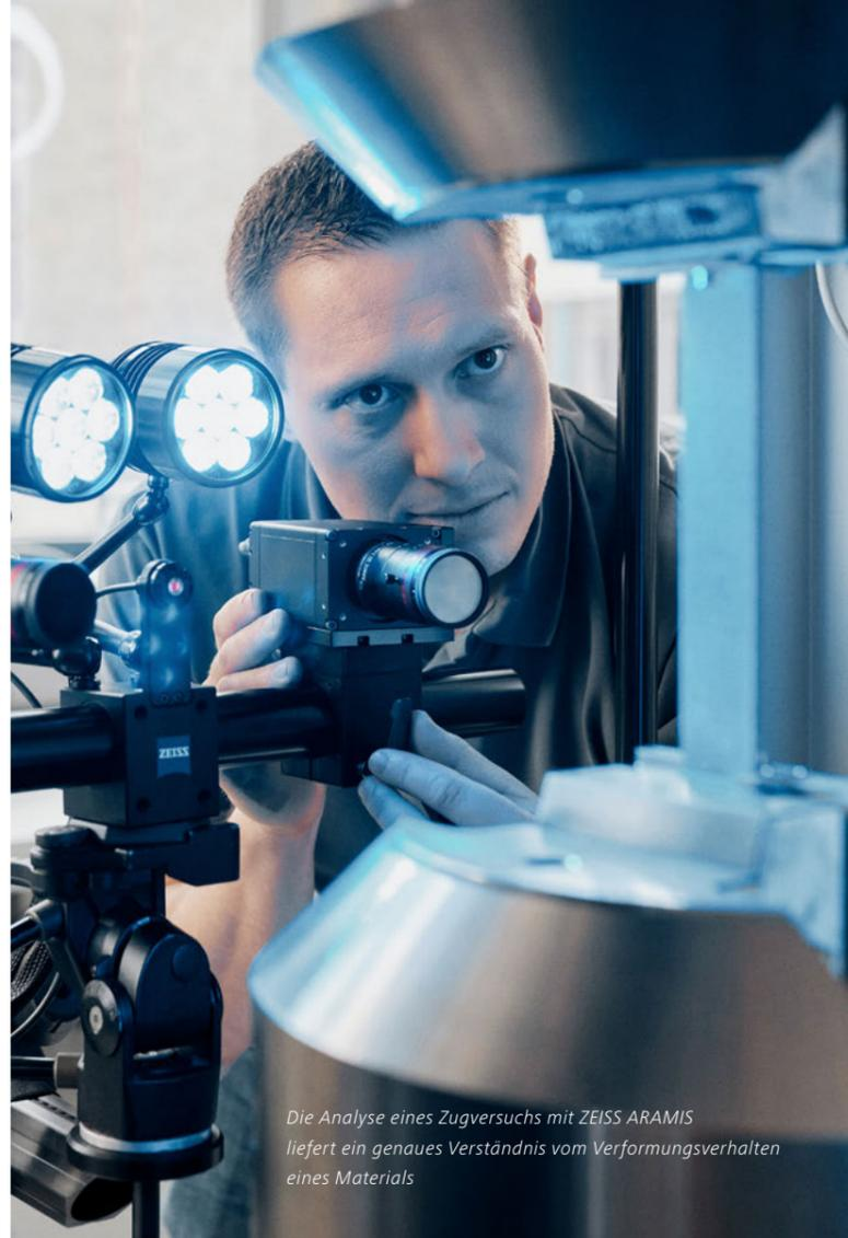
Die Analyse eines Zugversuchs mit ZEISS ARAMIS liefert ein genaues Verständnis vom Verformungsverhalten eines Materials
