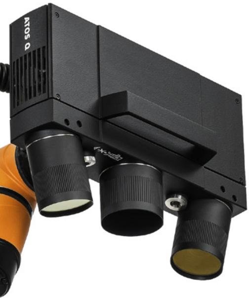
ATOS Q ist in zwei Versionen mit unterschiedlichen Kameraauflösungen erhältlich: 12 M und 8 M. Die 3D-Scanner erfassen beim Scannen bis zu  $2 \times 12$  Millionen oder  $2 \times 8$  Millionen Koordinatenpunkte. Die Genauigkeit, die Auflösung und die Messfeldgröße sind jeweils frei definierbar. Erhältlich sind fünf Präzisionsobjektive, mit denen verschieden große Messfelder abgedeckt werden: 100, 170, 270, 350, 500.
