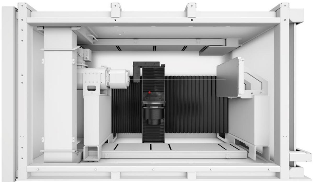
Eine 5-Achs-Kinematik mit integriertem Zentriertisch hilft Ihnen, das Bauteil optimal im Messvolumen zu positionieren. Sie legen das zu messende Bauteil einfach im Messraum ab – der Rest passiert in der Software. Dies garantiert, neben einer vereinfachten Gerätebedienung, dass jedes Bauteil
