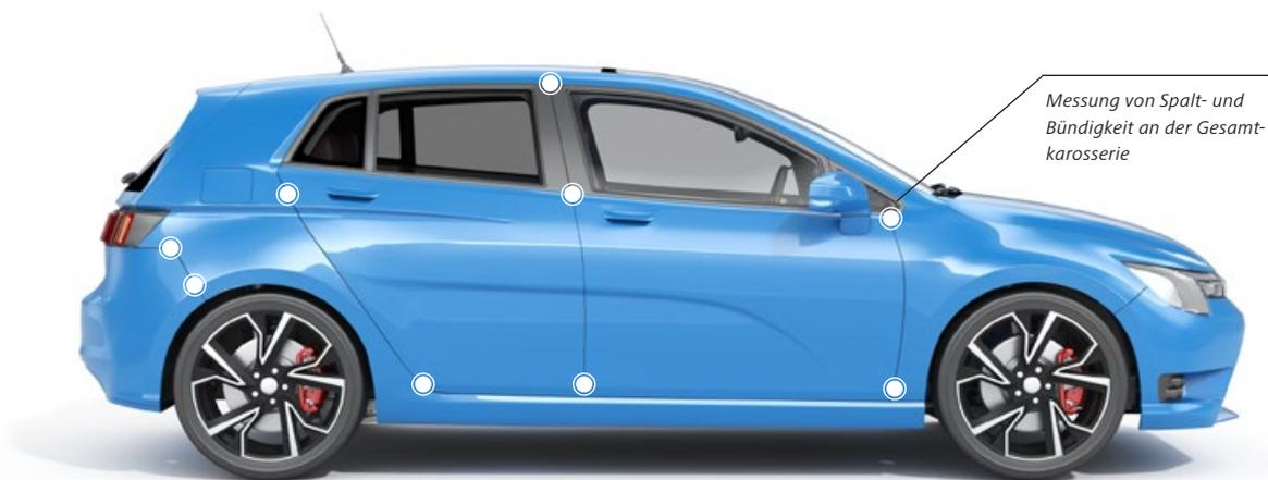
Bsp. Spalt- und Bündigkeit an der lackierten Karosserie auf der rechten Seite, mit neun Messpunkten (Spaltvorgaben: im Bereich von  $3,4\text{ mm} \pm 0,5\text{ mm}$  bis  $4,4\text{ mm} \pm 0,5\text{ mm}$ ).
