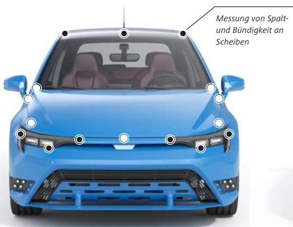
Bsp. Spalt- und Bündigkeit an der lackierten Karosserie im Bereich Front, mit 16 Messpunkten, davon sechs im Bereich Frontscheinwerfer (Spaltvorgaben: von  $0,8\text{ mm} \pm 0,8\text{ mm}$  bis  $4,4\text{ mm} \pm 0,6\text{ mm}$ ).
