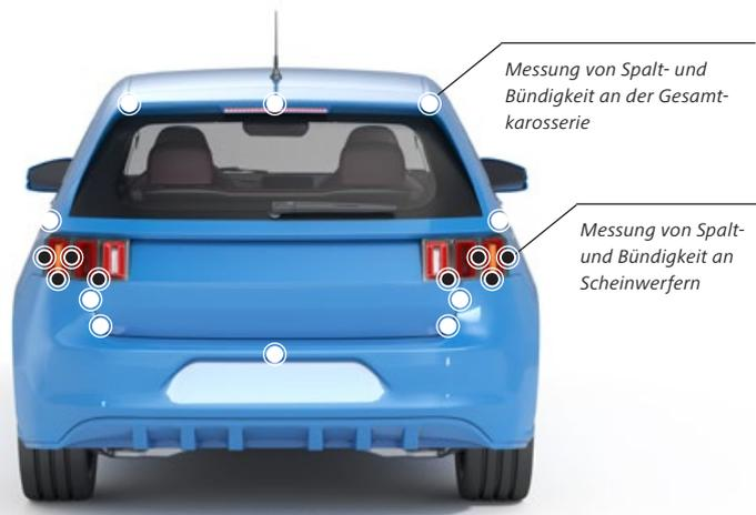
Bsp. Spalt- und Bündigkeit an der lackierten Karosserie im Bereich Heck, mit 18 Messpunkten, davon sechs im Bereich Heckenleuchten (Spaltvorgaben: von  $1,0\text{ mm} \pm 0,5\text{ mm}$  bis  $5,5\text{ mm} \pm 0,5\text{ mm}$ ).
