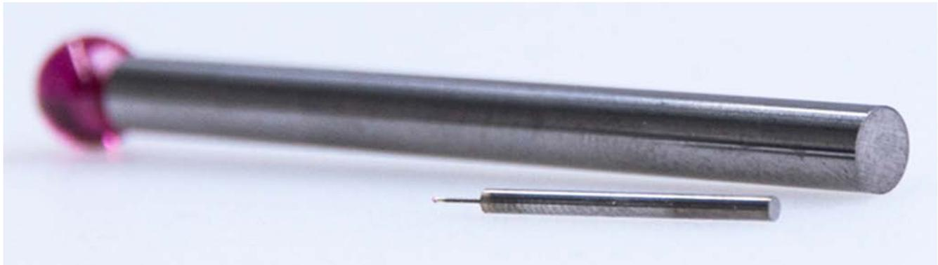
ZEISS Taster ohne Gewinde werden eingesetzt, um auch kleinste Charakteristiken von Bauteilen zu messen. Sie werden in entsprechenden Tasterhaltern fixiert. Das Tastelement ist entweder aus Rubin oder Siliziumnitrid der Tasterschaft besteht standardmäßig aus Hartmetall. Taster ohne Gewinde können mit den geeigneten Verbindungselementen zu verschiedenen Konfigurationen kombiniert werden, wie z.B. L-, T-, und Sterntastern.
