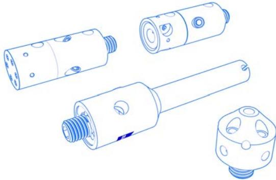
Klemmhalte werden eingesetzt wenn Taster ohne Gewinde verwendet werden. Selbst wenn der Taster abbricht kann der Halter wiederverwendet werden. Klemmtaster gibt es in unterschiedlichen Ausführungen. Meist werden sie als Halter für Sterntaster eingesetzt. Aber auch L-Taster und Einstellbare Winkeltaster finden sich im Portfolio.
