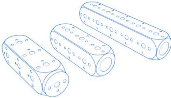
Mehrfachaufnahmen sind gefräste Tasterhalter, die in unterschiedlichen Ausführungen erhältlich sind. Vom Balken bis zu komplexen Winklelementen kann anhezu jede Form verwirklicht werden. Aufgrund der hohen Komplexität der Anforderungen beschränkt sich das Standardportfolio im M5 Bereich auf die gängigsten Formen. Eine höhere Flexibilität kann durch die Verwendung von M5 pro Elementen erreicht werden.
