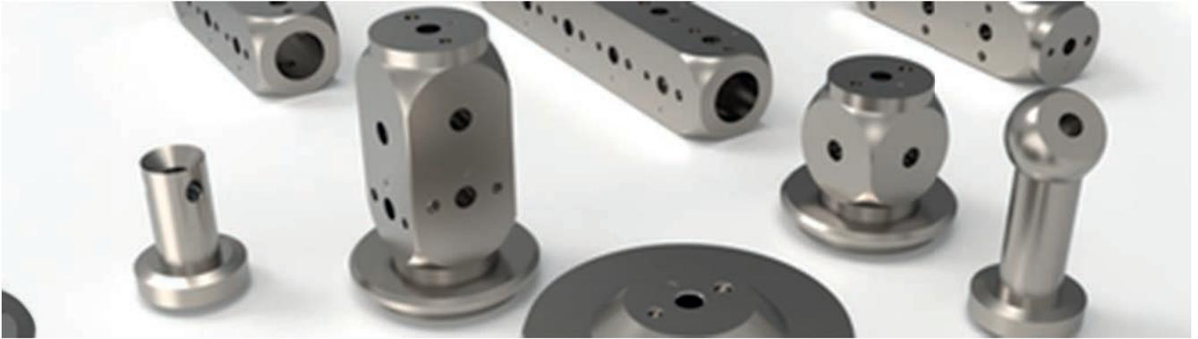
Als Ergänzung zum Standard M5 Portfolio bietet ZEISS die patentierte M5 pro Technologie an. Der Unterschied zwischen dem M5 pro System und den herkömmlichen M5 Verbindungsstellen besteht darin, daß die Verbindungselemente des M5 pro Systems über 2 Passtifte gefügt werden und damit exakt orientiert positioniert sind. Statt einem Gewindezapfen und rotatorischen Einschrauben werden die M5 pro Elemente gesteckt und von der gegenüberliegenden Seite mit einer zusätzlichen Schraube fixiert.
