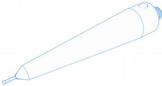
Kegelschafttaster haben einen vergrößerten Adapter, der sich erst kurz vor der Tastschuppe verjüngt. Dies führt zu deutlich besseren Steifigkeitswerten für den gesamten Taster. Umgekehrt wird die nutzbare Länge auf die eigentliche Messlänge reduziert, da die konische Kontur eine störende Kontur ergibt.
