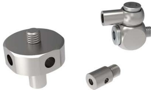
M3 REN Verbindungselemente werden für den Aufbau mehrfacher oder abgewinkelter Tasterkombinationen und Sterntaster mit M3-Gewinde verwendet. Das M3 REN System basiert auf Durchmesser 4 mm Grundkörpern und kann nur in Ausnahmefällen mit speziellen Adaptern mit dem M3 XXT System kombiniert werden.
