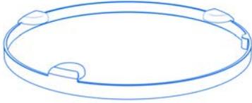
Diese Schutzringe werden zum Schutz der Wechselteller vor Beschädigungen im Einricht- und Messbetrieb oder bei der Lagerung verwendet. Die Kollisionsschutzringe bestehen aus Kunststoff und werden einfach über den Aluminiumkörper der Wechselteller gestreift. Dadurch sind die empfindlichen Kanten vor Stößen geschützt und die Teller können deutlich länger genutzt werden.
