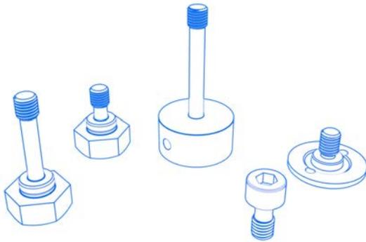
Schrauben zur Fixierung und Einstellung unterschiedlichster Verbindungselemente und Tastscheiben. Hinterschnittene Schrauben können durch Würfel hindurch in eine Verlängerung eingeschraubt werden. Dadurch ist eine Winkeleinstellung der nachfolgenden Komponente möglich. Die erforderliche Länge der Schraube richtet sich nach der Dicke des eingesetzten Würfels.
