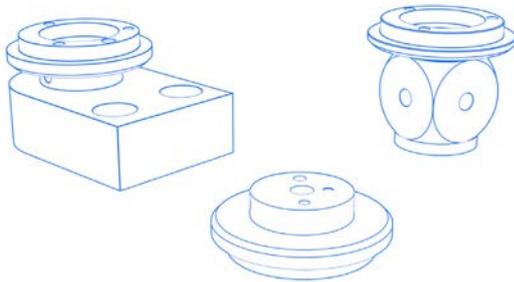
Sind bestehende Wechselteller am Würfel beschädigt, oder sollen spezielle, nicht mehr verwendete Wechselteller Typen umgerüstet werden ist es nicht nötig den kompletten Wechselteller neu zu beschaffen. Dafür gibt es Tellerwürfel und andere Telleradapter als Einzelemente, diese können einfach über die 3 Schrauben und die Ankerplatte am Tellergrundkörper befestigt werden. Tellerverlängerungen als Einzelemente finden sich im Bereich Verlängerungen
