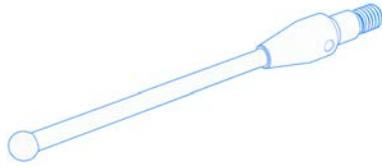
Klemmtaster haben im Vergleich zu herkömmlichen Stiften einen erweiterten Adapter. Dies bedeutet, dass er aus dem eigentlichen Adapter und einem Passzylinder zwischen dem Adapter und dem Gewinde besteht. So können die M3 XXT Sternelemente wie mit einer Klemmschraube direkt über den Stift eingespannt werden. Die anderen Abmessungen des Stifts entsprechen denen des vergleichbaren Standard-Stifts
