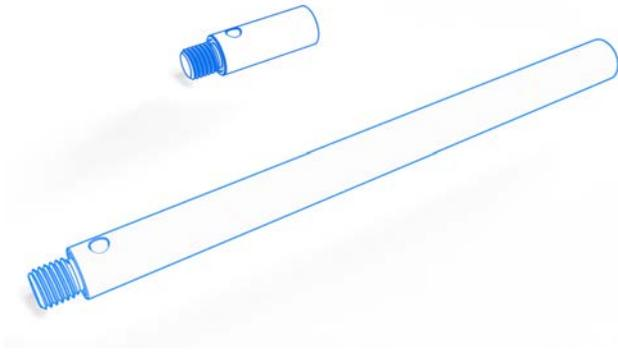
Standardverlängerungen M3 für schaltende Messköpfe haben mit Durchmesser 4 mm einen kleineren Außendurchmesser als Komponenten aus dem ZEISS M3 XXT System. Der daraus resultierende Verlust an Steifigkeit wird durch die Verwendung eines stabilen Titanstabs kompensiert. Das Gewicht dieser Verlängerungen ist geringer als bei vergleichbaren Verlängerungen aus Edelstahl, jedoch immer noch deutlich höher als M3 XXT Komponenten.
