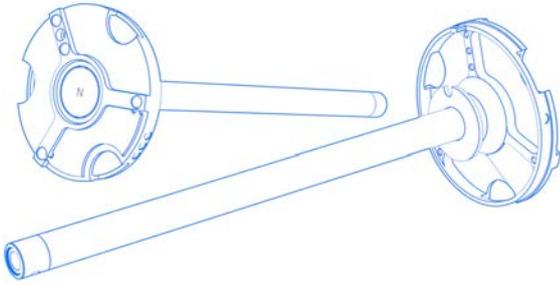
ZEISS VAST XXT TL4 Messköpfe werden speziell bei höheren Anforderungen in der Z-Länge der Tastersysteme eingesetzt. Sie können 15g an Gewicht aufnehmen, in X- und Y- Richtung sind sie jedoch eingeschränkt. ZEISS VAST XXT TL4 Messköpfe werden bei speziellen Applikationen auf allen Maschinen eingesetzt. Tastersysteme an VAST XXT TL4 Messköpfen haben folgende maximal zugelassene Dimensionen: Gewicht 10 g, Länge 250 mm, Auskragung 40 mm
