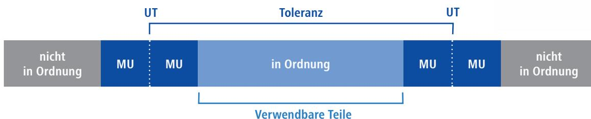
Mit ZEISS Originalzubehör können Sie zuverlässig hochqualitative Produkte liefern, indem die Messunsicherheit (MU) für jeden einzelnen Messpunkt minimiert wird.
