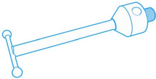
T-Taster bestehen aus zwei gegenüberliegenden Tastkugeln, die im 90° Winkel zum Schaft angebracht sind. Die Messtaster eignen sich besonders für die Messung von gegenüberliegenden Hinterschnidungen, wie etwa Nuten. Darüber hinaus können T-Taster auch bei schwer zugänglichen Messstellen (z.B. an der Unterseite des Werkstücks) eingesetzt werden.
