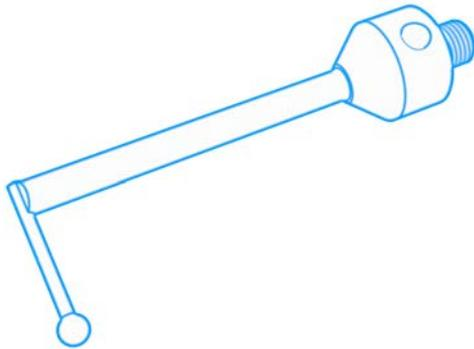
Bei L-Tastern steht die Tastkugel im 90° Winkel zum Tastschaft. Aufgrund ihrer L-Form eignen sich die Messtaster besonders gut für die Messung von Hinterschneidungen in Bohrungen. Darüber hinaus kann man mit einem L-Taster auch schwer erreichbare Stellen (z.B. an der Unterseite des Werkstücks) messen.
