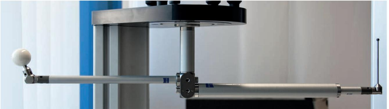
In der taktilen Messung von Werkstücken, kann es sein, dass die zu messenden Merkmale schwer zugänglich sind. In diesem Fall bedarf es einer Tasterverlängerung. Während für schaltende taktile Sensoren die Verlängerungen weiterhin aus Metall bestehen können, erobern Kohlefasern zunehmend die Welt der scannenden taktilen Sensoren.
