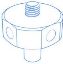
Würfel sind das gängigste Verbindungselement in einem Taster-system. ZEISS führt eine Vielzahl an unterschiedlichen Ausführungen für alle Anwendungen im Portfolio. Vom einfachen L-Würfel mit einer Anschlußmöglichkeit bis hin zu Mehrfachwürfeln, die u.a. bei der Zahnradmessung ohne Drehtisch eingesetzt werden. Standard Würfel werden entweder mit dem intergrierten Gewindezapfen oder mit einer zusätzlichen Schrauben fixiert.
