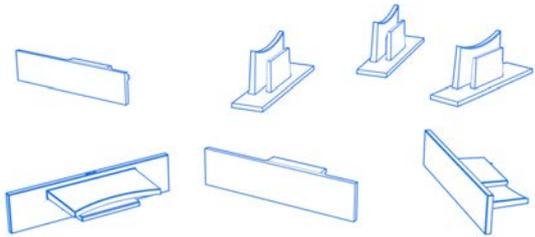
Werden unterschiedliche Tastersysteme in einem Messprogramm verwendet ist es notwendig diese auch entsprechend in der Programmierung zu vermerken. Dazu hat jedes Tastersystem eine eigene Bezeichnung, die vom Anwender selbst wählbar ist. Um diese dann voneinander zu unterscheiden sollten auch die Tastersysteme an sich entsprechend gekennzeichnet sein. dazu werden Kennzeichnungsschilder wie diese einfach m Wechselteller angebracht
