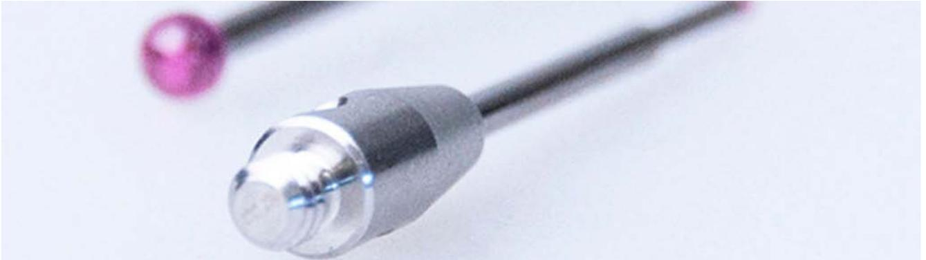
Taster mit M2-Gewinde sind vor allem für schaltende Messköpfe geeignet. Mit dem passenden Verbindungselement lassen sie sich auch mit anderen Gewindesystemen verbinden. Im M2-Bereich stehen Tastkugeln aus Rubin oder Siliziumnitrid zur Verfügung. Der Schaft besteht standardmäßig aus Hartmetall. Neben den Standard-Kugeltastern sind außerdem Zylindertaster, welche vollständig aus Hartmetall gefertigt sind, sowie Scheibentaster aus Keramik verfügbar.
