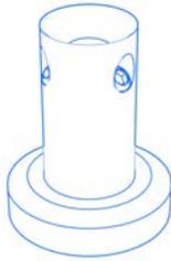
Bewegliche Elemente, wie Knickelemente, dienen dazu abgewinkelte Tasterkombinationen aufzubauen. Die Winkeleinstellung erfolgt quer zur Hauptachse des Knickelements. Drehelemente sind als komplette Dreheinheit oder als Basiselemente mit Kegelaufnahme (CR) erhältlich, dazu können Verbindungselemente mit Kegeladapter (CA) adaptiert werden.
