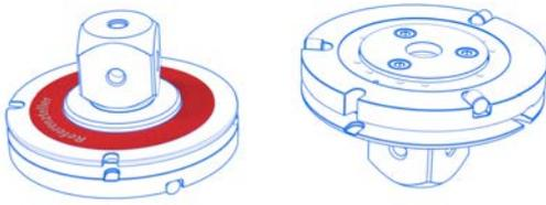
Referenz Wechselteller dienen zur Qualifizierung der Maschine und zur Referenzmessung der Einmesskugel. Die Referenz Wechselteller sind mit einem roten Ring gekennzeichnet und sollten nicht für Standardmessungen verwendet werden. Geeignet für Tastköpfe VAST XT Gold, VAST Gold, VAST C-G1 und VAST XTR Gold (keine Rotationsfunktion).
