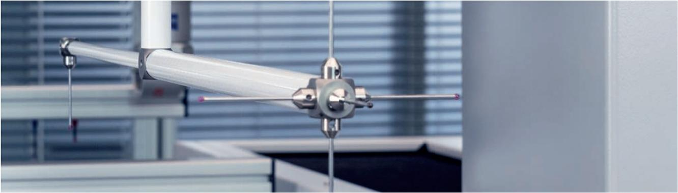
M5-Verlängerungen sind auf VAST-Tastersysteme zugeschnitten. In ihrer Vielfalt eint sie das Material (Länge größer 40 mm) und seine einmalige Verarbeitung: Sie basieren auf biege- und torsionsfester Kohlefasertechnik, die Lösungen aus Metall selbst im unteren Preissegment den Rang ablaufen. In den drei Qualitäten ZEISS REACH CFX® 1, CFX® 3 und CFX® 5 entsprechen die Verlängerungen der Genauigkeitsstufe des jeweiligen Koordinatenmessgeräts.
