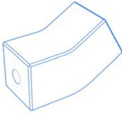
Mit speziell gefertigten Winkelstücken sind beliebige Winkel zwischen 0 und 90 Grad fest eingestellt. Der Vorteil dabei ist, daß der Winkel sich auch bei einer Kollision nicht verstellen kann. Diese Winkelstücke sind CNC gefräst und sind entsprechend genauer als von Hand eingestellte flexible Elemente. Natürlich geht dieser Vorteil auch mit einer Einschränkung der Flexibilität einher.
