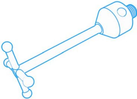
Sterntaster bestehen aus sternförmig kombinierten Tastern und ermöglichen Messungen in verschiedene Koordinatenrichtungen. Während des Antastens mit Kugel-Messtastern von den Seitenflächen nur begrenzt möglich ist, kann man beim Sterntaster jenen Taster zum Antasten wählen, der orthogonal zur angetasteten Oberfläche liegt
