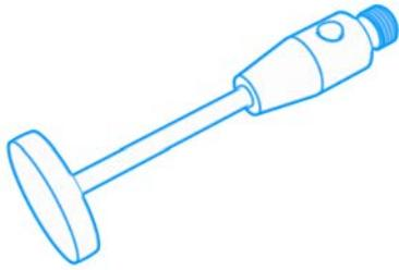
Scheibentaster werden u.a. zur Messung von rotationssymmetrischen Werkstücken mit Hinterschnitten oder von Einstichen und Bohrungen verwendet. Dabei tritt meist jedoch eine starke Filterung der Oberflächen-Rauheit auf. Mit der Bauform des Kugel-Scheibentasters wird im Vergleich zu Scheibentastern eine höhere Genauigkeit erreicht.
