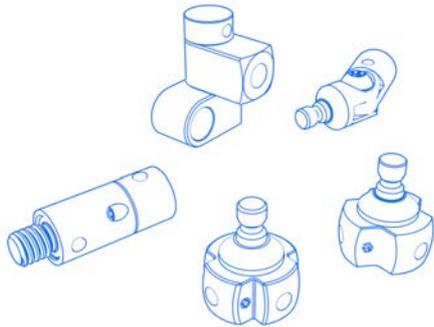
Ein Großteil der ZEISS Verbindungselemente haben eingebaute Kegeladapter (CA), der direkt in die Drehaufnahme oder die Kegelaufnahme (CR) einer Verlängerung eingesetzt werden kann. Somit können Würfel, Endwinkel, Stern, L- und T-Elemente sehr einfach und schnell ausgerichtet werden. Das Einstellen der Elemente über eine Schraube am Basiswürfel entfällt damit.
