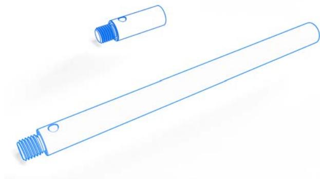
Standardverlängerungen M3 für schaltende Messköpfe haben mit Durchmesser 4 mm einen kleineren Außendurchmesser als Komponenten aus dem ZEISS M3 XXT System. Der daraus resultierende Verlust an Steifigkeit wird durch die Verwendung eines stabilen Edelstahlstabs kompensiert. Das Gewicht der Verlängerungen ist dadurch natürlich deutlich höher.
