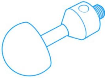
Halbkugeltaster eignen sich zur Messung von Hinterschneidungen sowie für jene Anwendungen, die einen großen Durchmesser der Tastkugel bei geringem Gewicht erfordern. Um diesen Effekt zu verstärken, unterscheidet man zwischen Halbkugel- und Hohlhalbkugeltaster. Bei den Hohlhalbkugeln wird durch ein aufwendiges Fertigungsverfahren eine zusätzliche Aushöhlung geschaffen um das Maximum an Gewichtersparnis zu erzielen.
