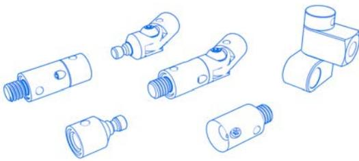
Bewegliche Elemente, wie Knickelemente, dienen dazu abgewinkelte Tasterkombinationen aufzubauen. Die Winkeleinstellung erfolgt quer zur Hauptachse des Knickelements. Drehelemente sind als komplette Dreheinheit oder als Basiselemente mit Kegelaufnahme (CR) erhältlich, dazu können Verbindungselemente mit Kegeladapter (CA) adaptiert werden.
