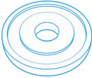
Tastscheiben werden u.a. zur Messung von Hinterschneidungen, Einstichen oder großen Bohrungen verwendet. Tasterscheiben können mit dem passenden Befestigungsmaterial direkt an Verlängerungen befestigt werden. Dabei tritt meist jedoch eine starke Filterung der Oberflächen-Rauheit auf. Mit der Bauform des Kugel-Scheibentasters wird im Vergleich zu Scheibentastern eine höhere Genauigkeit erreicht.
