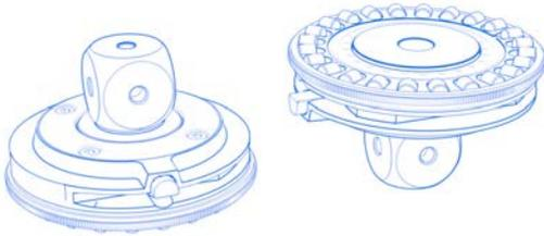
Der Zeiss Wechselteller wird bei der Aufnahme am Messkopf ausgelesen und erkannt. Für einen CNC gesteuerten automatischen Tastersystemwechsel wird der Wechselteller (inklusive der angebauten Elemente wie Taster und Verlängerungen) in der VAST XTR Ablage (600664-8600-000) platziert. Diese befindet sich im dafür vorgesehenem Tasterwechsellmagazin (MSR / ProMax).
