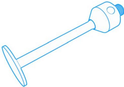
Scheibentaster werden u.a. zur Messung von rotationssymmetrischen Werkstücken mit Hinterschnitten oder von Einstichen und Bohrungen verwendet. Dabei tritt meist jedoch eine starke Filterung der Oberflächen-Rauheit auf. Mit der Bauform des Kugel-Scheibentasters wird im Vergleich zu Scheibentastern eine höhere Genauigkeit erreicht.
