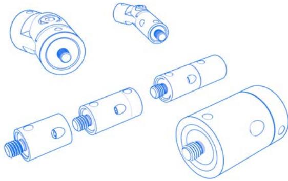
Bewegliche Elemente, wie Knickelemente, dienen dazu abgewinkelte Tasterkombinationen aufzubauen. Die Winklereinstellung erfolgt quer zur Hauptachse des Knickelements. Drehelemente sind als komplette Dreheinheit oder als Basiselemente mit Kegelaufnahme (CR) erhältlich, dazu können Verbindungselemente mit Kegeladapter (CA) adaptiert werden.
