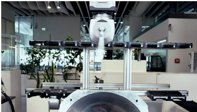
Der gelenkige Schwenktaster ersetzt mehrere Konfigurationen mit festen Tastern, da sich sein Taster motorgetrieben und softwaregesteuert in einer Ebene schwenken lässt.
