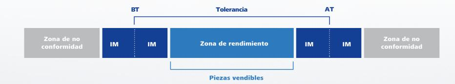
Los Accesorios Originales de ZEISS le permiten suministrar de forma fiable productos de alta calidad minimizando la incertidumbre de medición (IM) para cada punto de medición individual.
