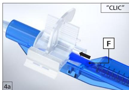
Empujar suavemente el émbolo hacia la posición de parada intermedia hasta llegar a la punta de la tapa de seguridad (F) y oír un "clic". Empujar el émbolo hacia la posición de parada intermedia es obligatorio para asegurar que la lente permanece en la posición prevista mientras se retira la tapa de seguridad.
