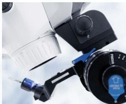
**Paquete de láser:** es posible adaptar fácilmente el láser quirúrgico, incluyendo una innovadora parada de enfoque del microscopio y un control deslizante de enfoque externo.
