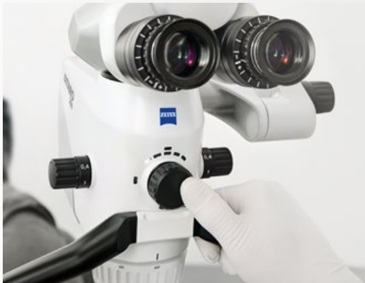
Aktivierung der Visualisierungs- und Aufnahmemodi sowie der Lichteinstellungen
