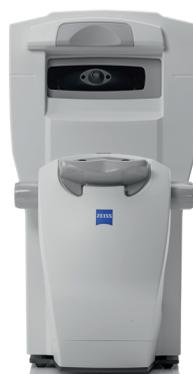
*ZEISS VISUPLAN 500 permite medir la presión intraocular de forma cómoda y sin contacto.*
