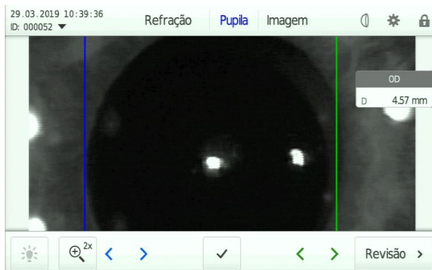
Fig. 41 Tela de medição para determinação do diâmetro da pupila com ampliação dupla
