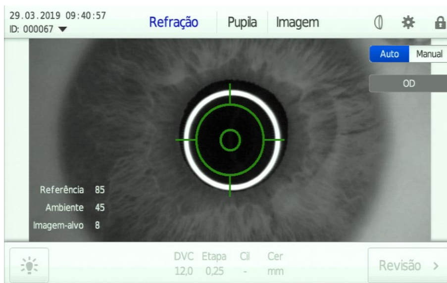
Fig. 29 Exibição dos parâmetros de iluminação definidos pelo usuário na tela de medição do modo Refração
