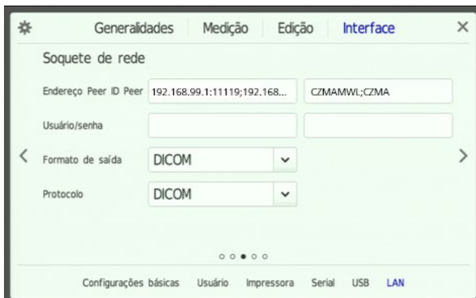
Fig. 11 Inserir endereço e ID Peer, assim como escolher o formato de saída e o protocolo
