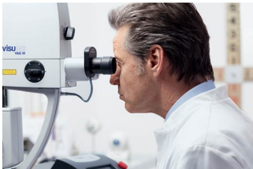
L'oculaire ACCENTO incruste les paramètres dans le champ de vision
