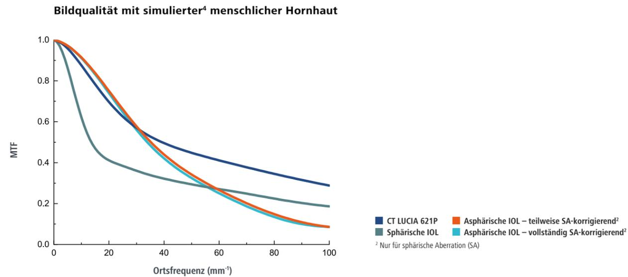
Abb. 2: Modulationstransferfunktion (MTF) verschiedener Optiken in einem Augenmodell mit einer simulierten menschlichen Hornhaut bei einer Apertur von 4,5 mm und einer Linsendezentration von 0,5 mm<sup>4</sup>
