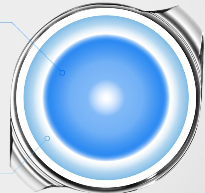
Abb. 5: Aberrationsprofil der ZEISS CT LUCIA 621P/PY mit ungleichförmig verteilten Brechkraftwerten (schematische Visualisierung, nicht maßstabsgetreu)
