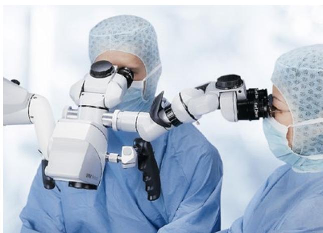
Avec le microscope OPMI Sensera® de ZEISS, le chirurgien peut déplacer le système sans effort dans une position confortable pour réaliser une opération de l'oreille, du nez ou de la gorge. Une simple pression sur un bouton suffit pour que le système d'équilibrage novateur effectue une stabilisation parfaite du microscope, même lorsque tous les accessoires sont utilisés.
