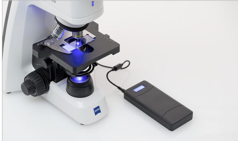
*In abgelegenen Gebieten ohne gesicherte oder stabile Stromversorgung kann Primostar 3 iLED über die Powerbank betrieben werden.*
