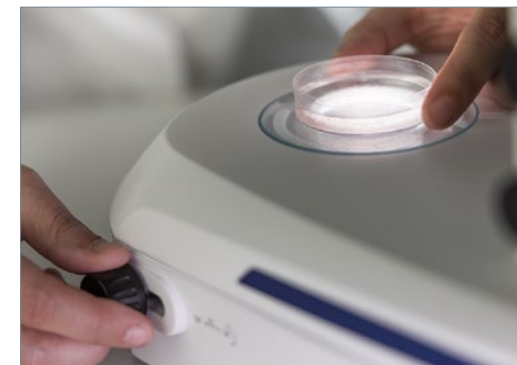
Lo specchio mobile e inclinabile è dotato di campo chiaro, campo scuro unilaterale e luce obliqua, oltre al contrasto di polarizzazione opzionale. Ruotolo sul lato satinato o quello liscio, quindi scegli tra il contrasto del campo chiaro nitido e quello diffuso.
