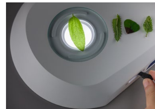
Utilizza l'unità di luce trasmessa piatta per contrastare campioni trasparenti colorati in campo chiaro e scuro. Aggiungi un polarizzatore/analizzatore per osservare, ad esempio, cristalli birifrangenti o tensioni nel vetro o nella plastica.
