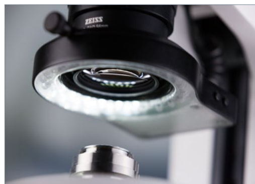
La luce ad anello priva di ombre presenta quattro diverse modalità di segmento: intero, mezzo e quarto di cerchio e 2 quarti di cerchio opposti. Imposta l'illuminazione del segmento, quindi ruota manualmente la direzione della luce con incrementi di 90° per ispezionare rapidamente graffi, difetti o residui senza spostare il campione. Oppure utilizza la modalità di rotazione automatica per ottenere un'impressione spaziale della superficie dell'oggetto semplicemente cambiando le ombre.
