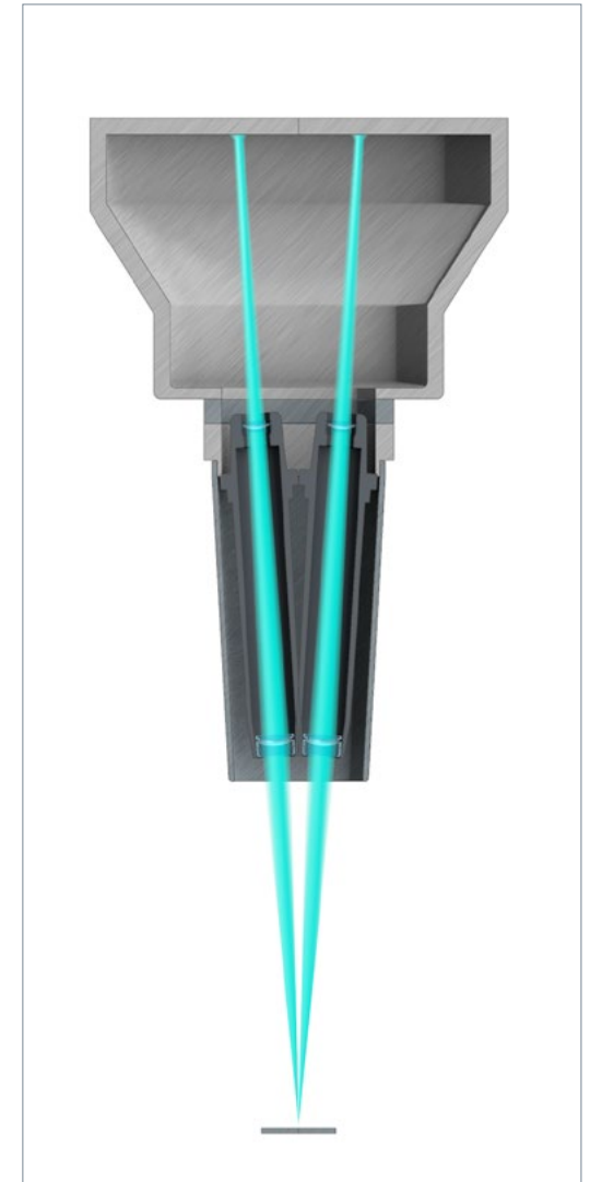
Percorso ottico di uno stereomicroscopio di tipo Greenough
