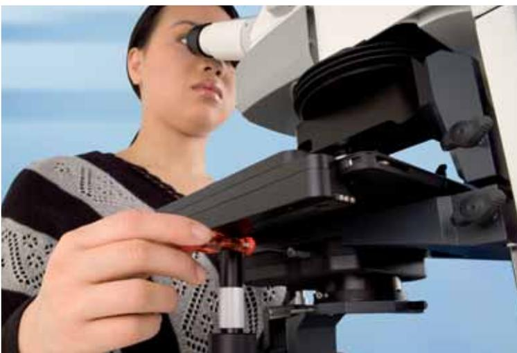
*Neue Maßstäbe schon mit dem einfachsten Kontrastverfahren: die im Kondensator integrierte Segmentblende für die Schrägbeleuchtung kann um 360° gedreht und damit optimal an die Probenstrukturen angepasst werden.*
