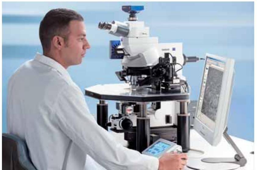
*Remote Control: alle motorischen Funktionen lassen sich per Docking Station und AxioVision Software bedienen.*
