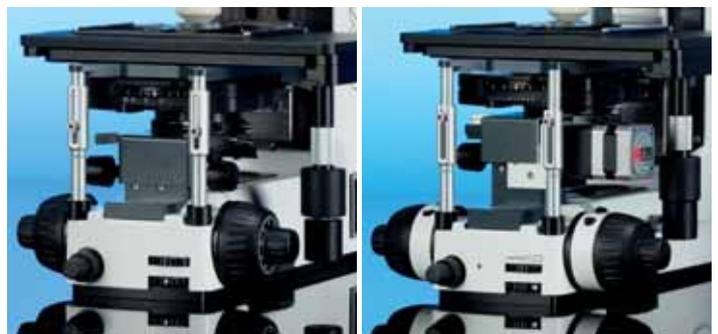
*Durchdacht an vorderster Front positioniert: die Bedienelemente für Fokustrieb, Tischtrieb und Kondensortrieb, für die Auswahl von sichtbarem oder infrarotem Licht, für die Einstellung der Leuchtfeldblende, die Regelung der Lichtintensität und für alle Kontrastverfahren im Durchlicht. Zudem sind am motorischen Stativ (rechts) alle Motorfunktionen über die Tastenringe am Fokustrieb bedienbar.*
