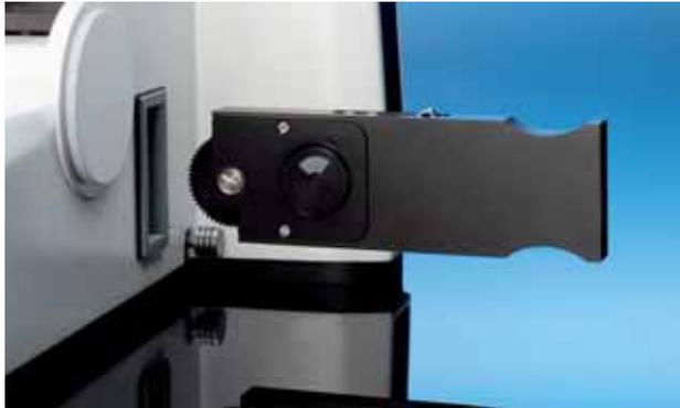
*Der Dodt-Kontrastschieber befindet sich in der Aperturblendenebene...*
