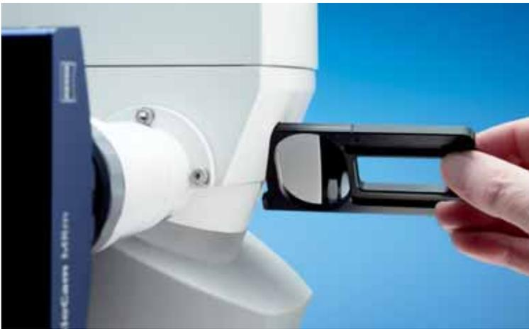
Der Schieber für die Sideport-Auskopplung: zusammen mit einem Fototubus bereits ein Dual Kamera-System
