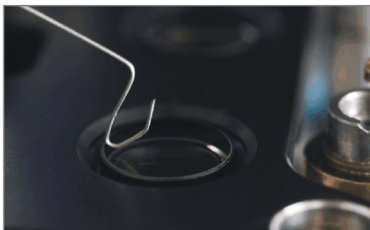
使用计算机控制的工具使变倍透镜精确定位到变倍体...
