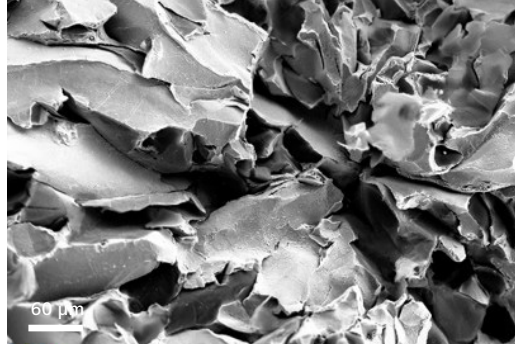
Kırılma yüzeyi - çelik numunenin gerilimde kolayca kırılması. Numune: The Test House, Cambridge, Birleşik Krallık'ın izniyle.
