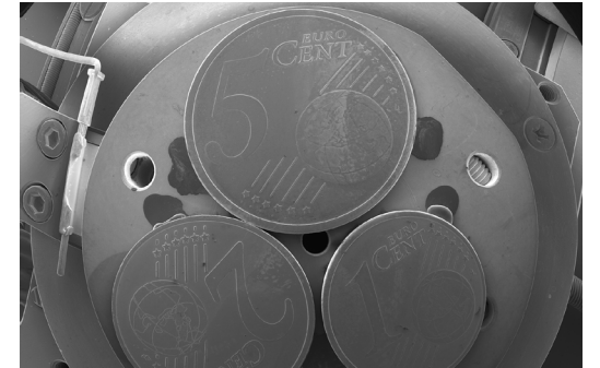
Genel bakış modu, son derece geniş bir görüş alanı sunar ve kolay gezinme ve ROI'lerin hızlı bir şekilde yeniden konumlandırılmasını sağlar. Görüntü, SE2 dedektörü kullanılarak 5 kV'ta alınır.
