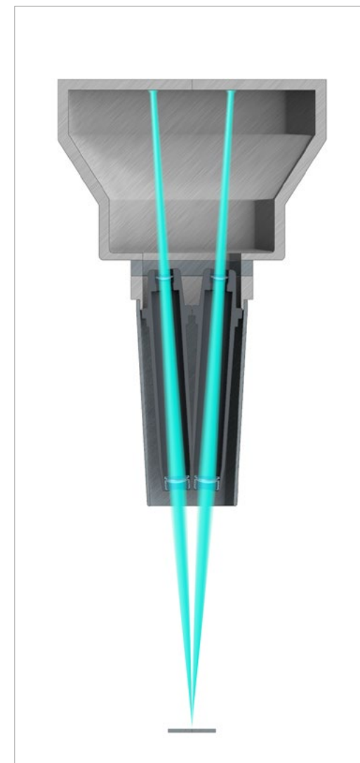
Схема прохождения лучей в стереомикроскопе по схеме Грену
