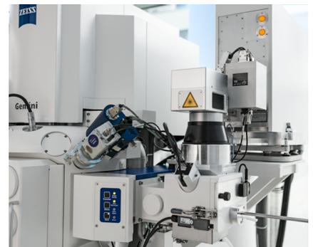
LaserSEM のフェムト秒レーザーは、専用のレーザー準備チャンバーであるエアロック上に設置されているため、メイン装置チャンバーへの不純物混入を防止し、2つの装置間のシームレスな往復を可能にします。また、高い再現性とスループットが要求されるプロセスには、半自動装置もオプションでご利用いただけます。SEM とレーザーをシームレスに組み合わせることにより、学術研究機関や産業研究開発ラボの研究者は、電子工学、エネルギー、ナノ材料などのあらゆる分野のアプリケーションにおいて、高分解能イメージングや、EDS、EBSD などの FE-SEM のあらゆる解析機能に直接かつ同時にアクセスすることができます。
