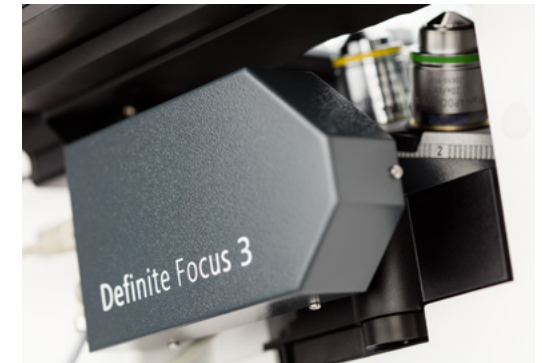
Definite Focus 3 ist in den Objektivrevolver von Axio Observer 7 integriert.
