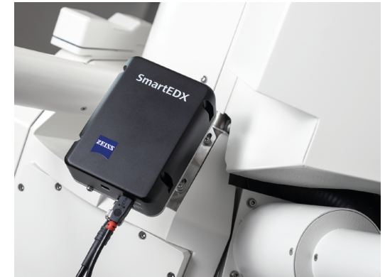
ZEISS SmartEDX (stationäre Ausführung): ultrakompaktes Design mit Peltierkühlung
