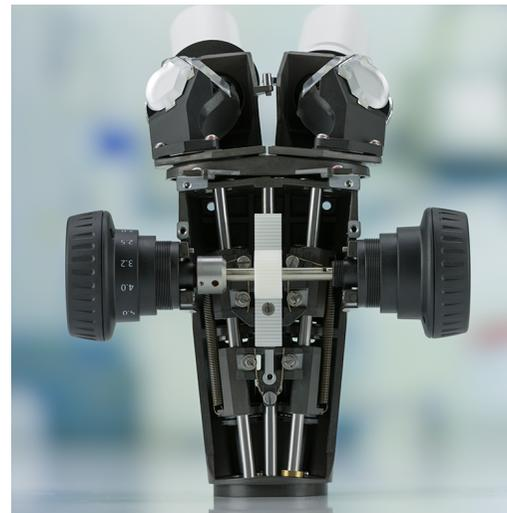
ZEISS Stemi 508 verfügt über ein nach dem Greenough-Prinzip funktionierendes optisches System mit leistungsstarkem 8:1-Zoom. Die beiden Zwillingstubuskörper sind im Winkel von 11° geneigt und liefern ein beeindruckendes Stereobild.
