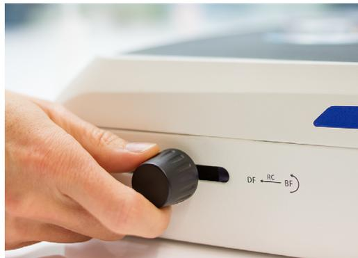
*Durchlichteinheit M LED – der kipp- und verschiebbare Spiegel bietet die Optionen Hellfeld, einseitiges Dunkelfeld und Schrägl. Durch Drehen zur regulären und satinierten Spiegelseite können Sie zwischen gestochen scharfem und diffusem Hellfeldkontrast wählen. Ergänzen Sie optionalen Polarisationskontrast.*
