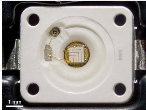
Besonders heller LED-Chip, Bonddrähte und Verpackung
