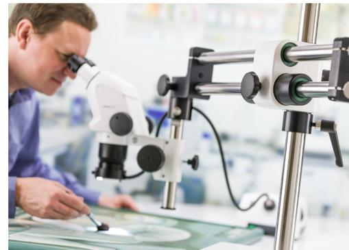
*Der horizontale Kugellagerarm des Doppelarmauslegerstativs SDA sorgt für einen großen Verfahrbereich und eine federleichte Schwenkbewegung. Wenn Sie Ihre Probe mithilfe der variablen Frontlinse fokussieren (anstatt den Fokussiermechanismus zu verwenden), ...*
