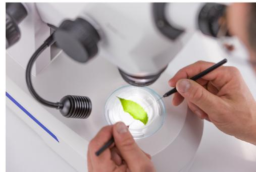
*Die kompakte Durchlichteinheit des Stativs K LAB mit kippbarem Spiegel bietet die Optionen Hellfeld, einseitiges Dunkelfeld und Schräglicht. Ergänzen Sie die Doppelspotleuchte K LED, um Dissektionen in Aufsicht durchzuführen.*
