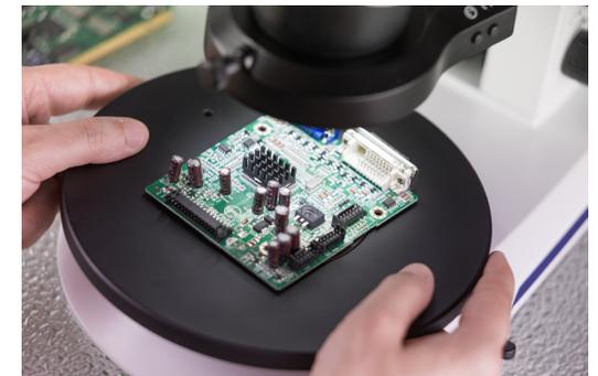
*Das Stativ K MAT ist mit Aufsichtsteuerungen und ESD-Funktionen (antistatische Beschichtung) ausgestattet und optimiert so Ihr Stemi 508 für die PCB-Inspektion oder die Kleinteilmontage in der Elektronikindustrie. Ergänzen Sie das segmentierbare Ringlicht K LED als Beleuchtung und einen Gleit- oder Kugelgelenktisch, um Proben präzise zu positionieren.*
