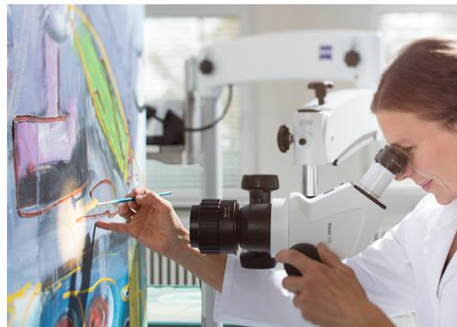
*Das mobile Bodenstativ S deckt einen größeren Probenbereich ab als alle anderen für Stemi 508 erhältlichen Stative. Es wird zur Beobachtung von großen, schweren oder unbeweglichen Proben wie Fahrzeugmotoren, großen Tieren, lebenden Pflanzen, Skulpturen oder Wandgemälden verwendet.*
