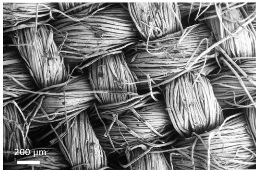
Der C2D-Detektor erzeugt ausgezeichnete Bilder von unbeschichteten Proben im variablen Druckmodus, was für forensische Vergleiche von Fasern ideal ist.
