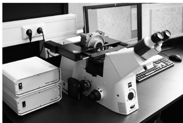
図1 大型非鉄鋳造部品のマクロセクションの微細構造解析。顕微鏡の反転設計により、より簡単かつ迅速に分析を行うことができます。試料を切断して載せる必要はありません。これらの検査試料は焦点面に直接位置するため、大型あるいは大重量の試料も直接検査することができます。
