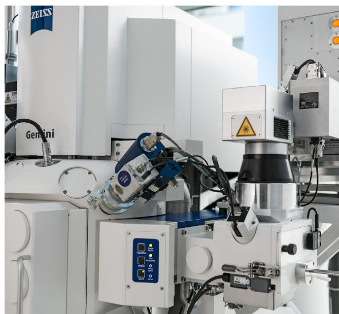
図 1：LaserFIB：新しいフェムト秒レーザーを搭載した ZEISS Crossbeam
