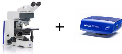
蔡司 Axiomscope 5 可单机完成显微成像，无需电脑。
