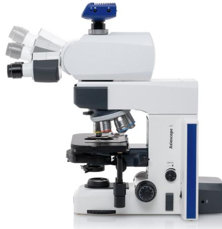
观察视野为 25 mm 的人体工程学拍照镜筒，倾斜范围为  $-2^{\circ}$  至  $+28^{\circ}$ 。也适用于共同观察装置。
