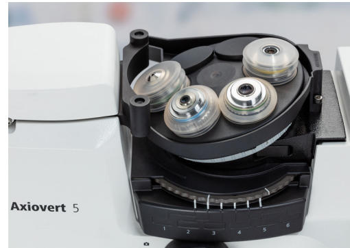
O Aquastop II protege as objetivas e outros componentes ópticos dentro do microscópio contra líquidos derramados.
