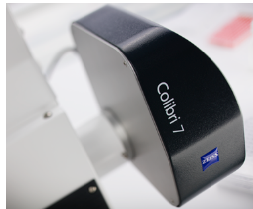
Colibri 7 instalado diretamente na estativa, possibilitando maior intensidade luminosa – ajuste livre e sem necessidade de guia de luz.
