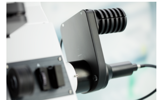
Carrossel de filtros de excitação para imagens multicoloridas de alta velocidade.
