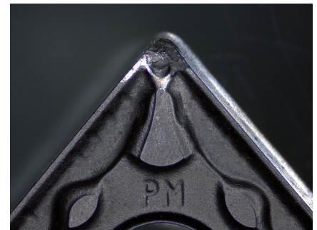
Wendeschneidplatte mit Zeichen von Werkzeugverschleiß. Auflicht, Ringlicht, Zoom 0,8-fach
