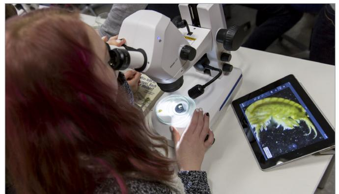
**Figura 11** Estudiantes trabajan con una Stemi 305 cam. La imagen del microscopio se puede visualizar mediante la aplicación Labscope en el iPad.
