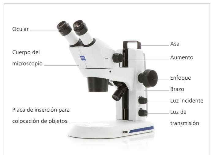
Figura 2 Estructura de un microscopio estereoscópico
