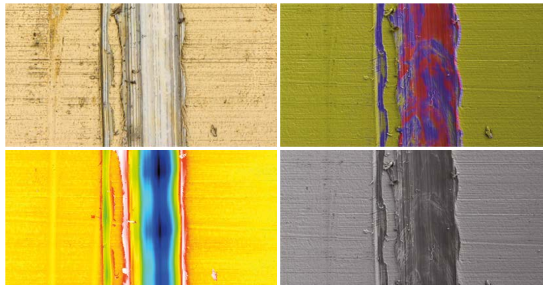
電子接点上の摩滅の跡の検査: 光学顕微鏡 (LM) を用いて広視野、拡張被写界深度で取得した画像 (左上)、走査電子顕微鏡 (SEM) を用いたエネルギー分散型 X 線分光法 (EDS) によるマッピング (右上)、色分け表示した高さマップ (左下)、SEM での反射二次電子 (BSE) シグナル (右下)。
