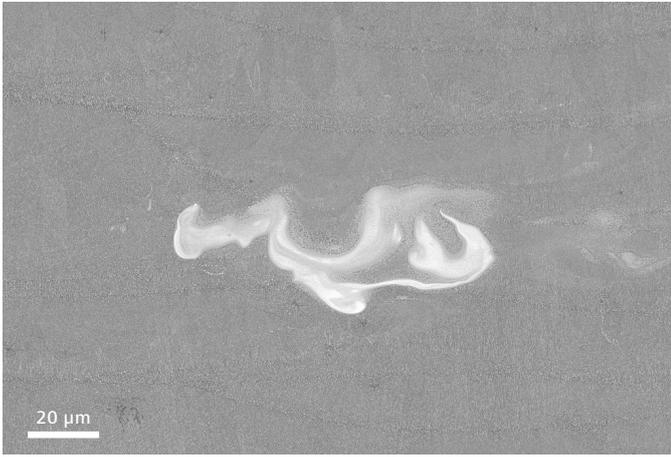
図 2: 積層造形製高温 Al 合金断面の SEM 像。微細構造が確認できる
