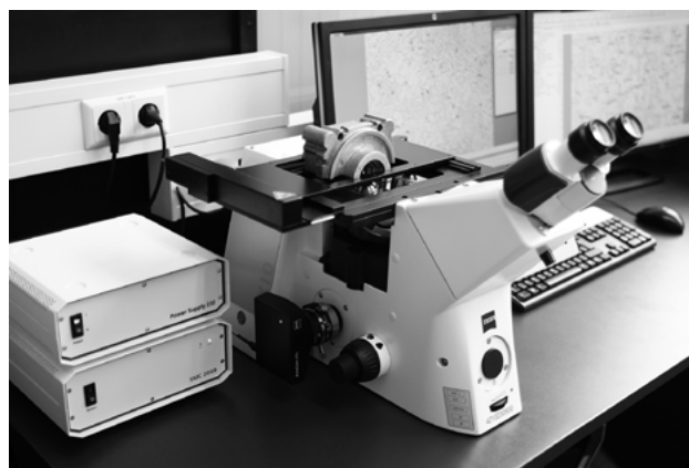
图 1 有色金属铸件不规则大尺寸样品的显微结构分析。倒置显微镜可以让用户在执行此类分析时更方便、更快捷。样品无需切片和镶嵌；通过直接放置于载物台上即可对待测表面进行观察，从而实现对大而重样品的直接检验。
